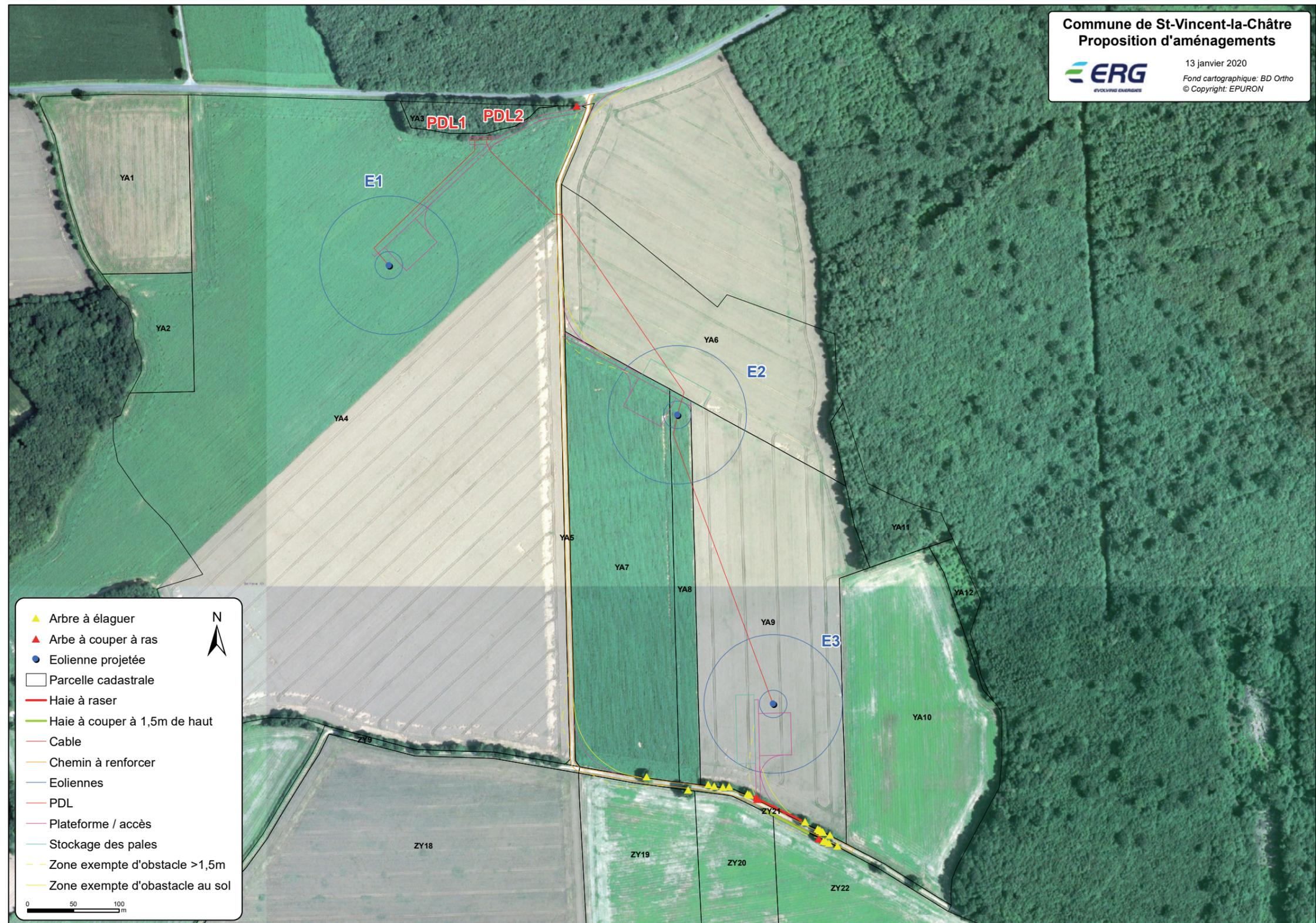
Carte 41 : Plan d'ensemble laissant apparaître les travaux de coupe et de taille de végétation nécessaires à la construction du parc éolien.
